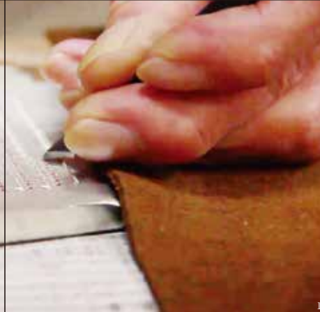
1. タガネで目を立てる作業 2. 大矢製作所のスタッフ 3. 機械で刃を付けたおろし金でおろした大根おろし（左）と大矢製作所のおろし金でおろした大根おろし（右）大矢製作所のおろし金は細胞が潰れないため水分が逃げない。
